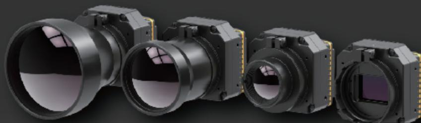
PLUG系列非制冷标准机芯基于高芯科技自产金属封装非制冷红外探测器，搭配全系列光学组件，通过专业的信号处理电路以及图像处理平台，将目标红外辐射完整还原成温度数据，并以清晰的热像图呈现。我们将凭借在红外测温领域多年的技术积累和实战经验，提供全方位机器热成像视觉解决方案，致力为工业测温领域开启全新视野。
